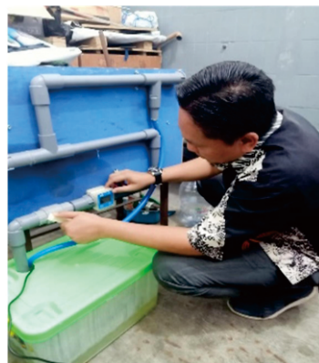
Gambar 5. Instalasi korosi kupon
