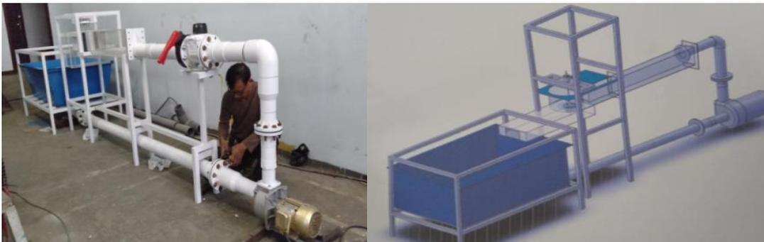
**Gambar 1. Turbin vortex di laboratorium**
