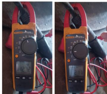
Gambar 2. Proses Pengecekan Welding Parameter Pada Saat Proses Pengelasan.
