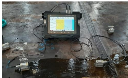
Gambar 11. Memastikan Rolling Direction Pelat Yang Melintang Dengan Weld
